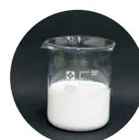
特殊ゴムラテックス(SBR)に亜硝酸リチウムを高濃度に添加した水性混和剤。(亜硝酸リチウム16%
