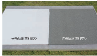
高反射塗料の有無による防水層表面温度の差をサーモグラフで比較
